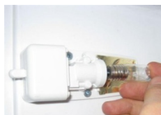
Ersetzen Sie die Glühlampe
