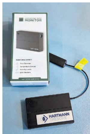
Mit solchen Monitoren, die im Innern des Tresors deponiert werden, lassen sich Erschütterungen, Luftfeuchtigkeit und Temperatur überwachen.
